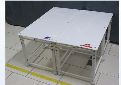
As colunas de 42mm e vigas de 30mm sustentam uma placa de 6mm de espessura, de alta resistência a impactos.
